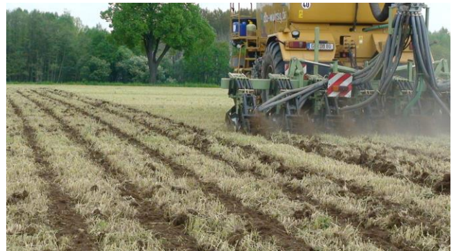
Abbildung 2: Streifenbearbeitung zu Mais mit gleichzeitiger Ausbringung von Gärrest
