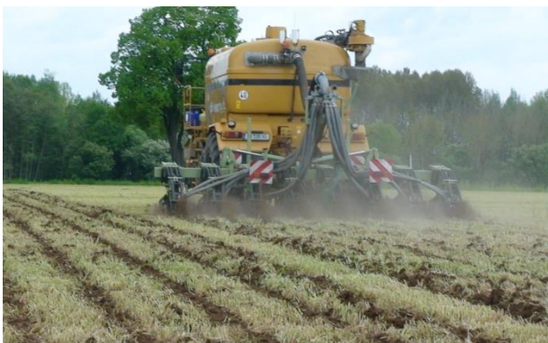
Abbildung 4: Streifenbearbeitung mit dem Maxplacer von Orthman
